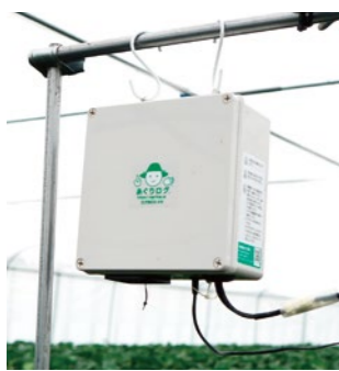
あぐりログを導入 (ハウス内の温度や湿度などの環境データを測定する装置)
